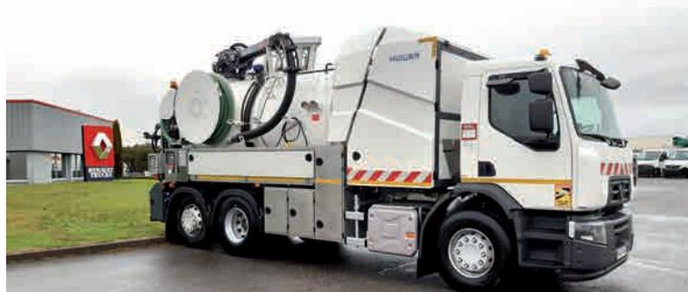
Le Medium CD avec cloison déplaçable dans une citerne d'une capacité de 11 000 litres.
