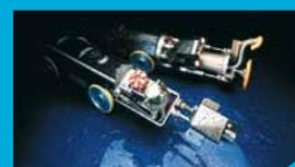
→ Installation d'une caméra de téléinspection dans une canalisation d'assainissement.
