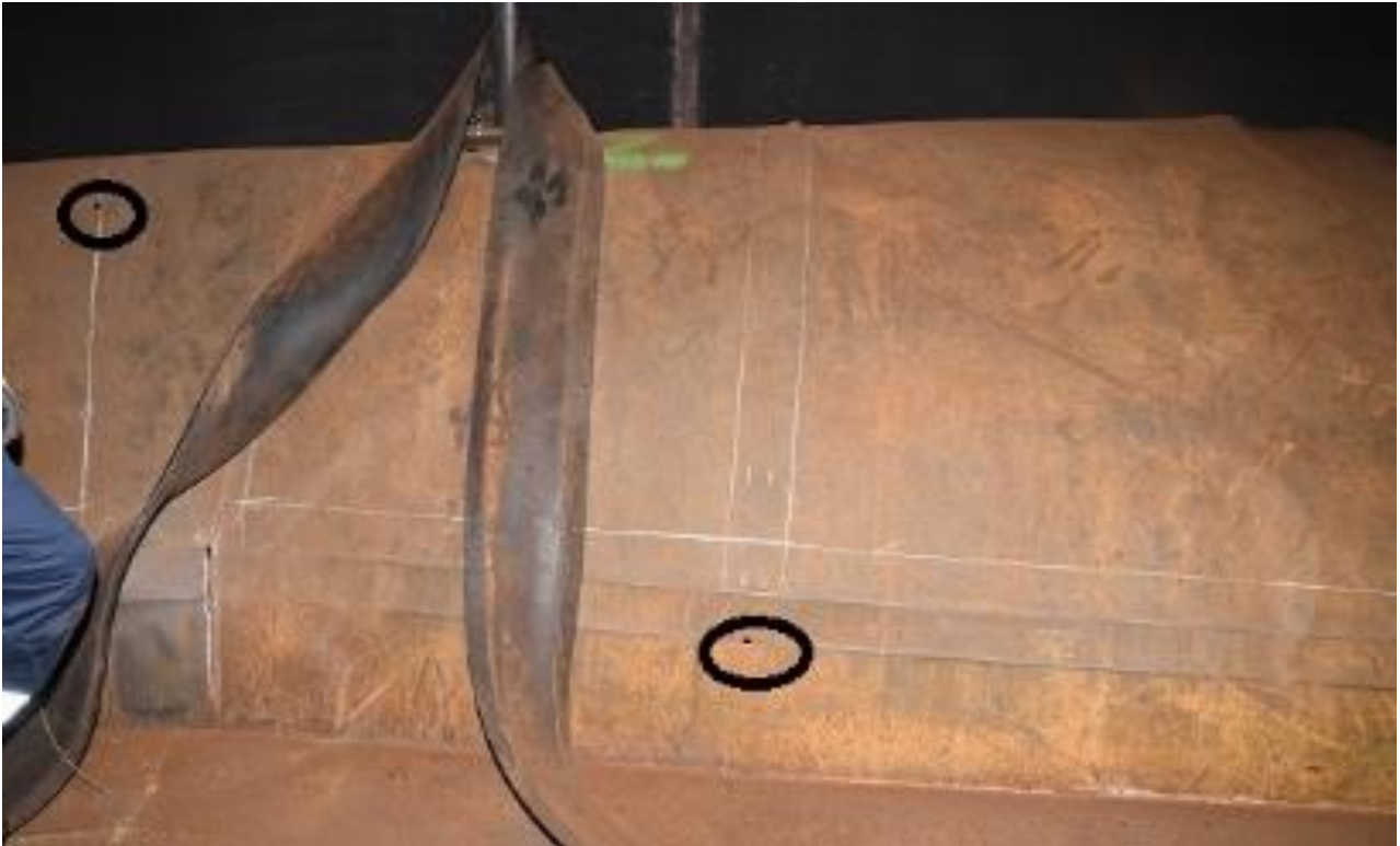
Figure 12 : positionnement des ouvertures
