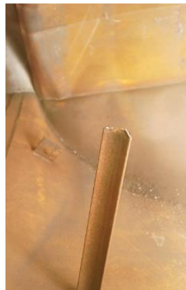
Figure 16 : soudure de renfort arrachée coté intérieur du caisson
