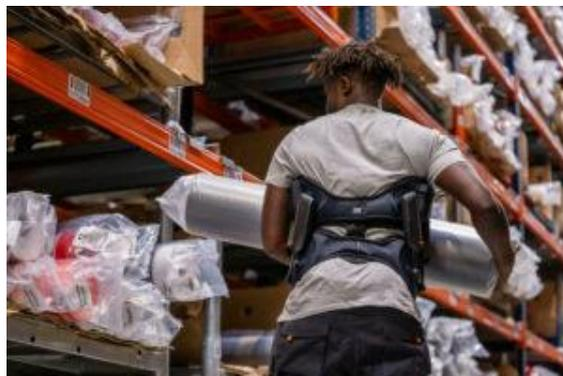
L'exosquelette Japet.W est pourvu de deux micromoteurs pour soulager le dos. © Japet Medical
