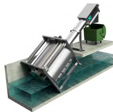
Le tamis rotatif incliné Noggerath RSI-DD de Passavant Geiger se caractérise de la technologie conventionnelle par un tambour de tamisage et un transport des déchets entraînés indépendamment l'un de l'autre.
